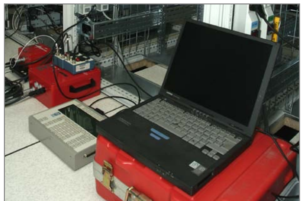
Meetsysteem voor trillingsbewaking: continue registratie, frequentieanalyse, alarmfunctie bij het naderen of overschrijden van grenswaarden
