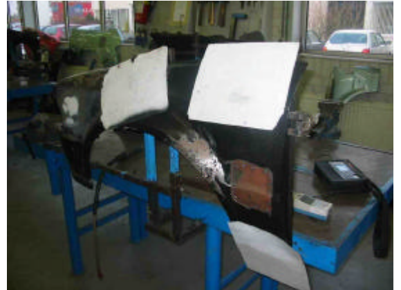
Magnetische dempingsmatten op te bewerken autocarrosserie
